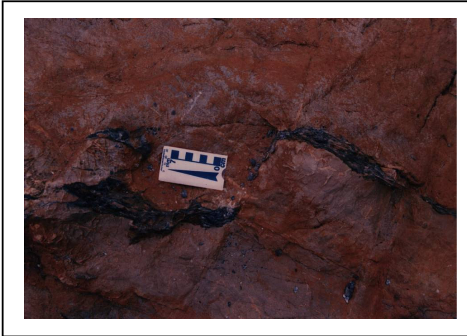
FOTO 23: Cisalhamento rúptil em mármore da Formação Betara, deslocando camada de xisto intercalado. Este fraturamento é decorrente do sistema Fn+1. Pelo modelo de Riedel esta fratura seria o cisalhamento R', antitético em relação ao cisalhamento transcorrente principal. (Afloramento no chão. - Pto. E - 75)
