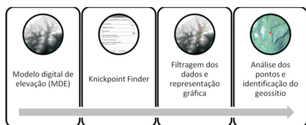
Figura 5 – Sequência de etapas necessárias para se identificar um geossítio a partir de um modelo digital de elevação utilizando-se o software Knickpoint Finder.
